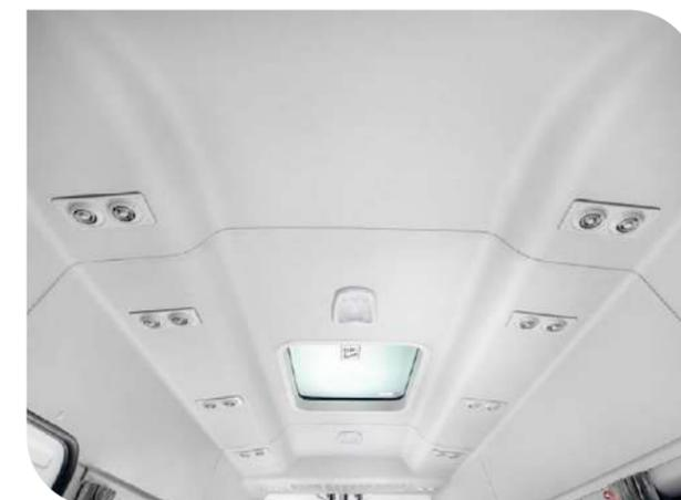
Климатическая установка увеличенной мощности (8 кВт) с отдельным кондиционером для пассажирского салона, купольный свет и эвакуационный люк — оснащение, отвечающее самым современным стандартам.
