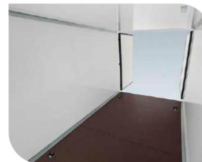
Настил пола — транспортная фанера со встроенными петлями для крепления грузов
