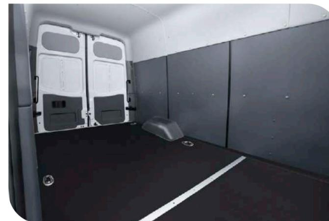
Обивка стен и покрытие пола выполнены из прочных материалов для защиты грузов и долговременной эксплуатации фургона. Петли крепления груза. Поручни задних распашных дверей. Грузовой отсек готов к полноценной эксплуатации прямо с конвейера.
