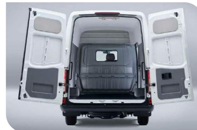
Перегородка со смотровым окном. Близкая к прямоугольной форма грузового отсека даёт коэффициент использования 95%. Всё должно работать на вас.
