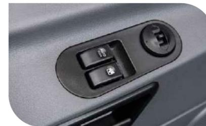
Электростеклоподъемники и электрорегулировка зеркал
