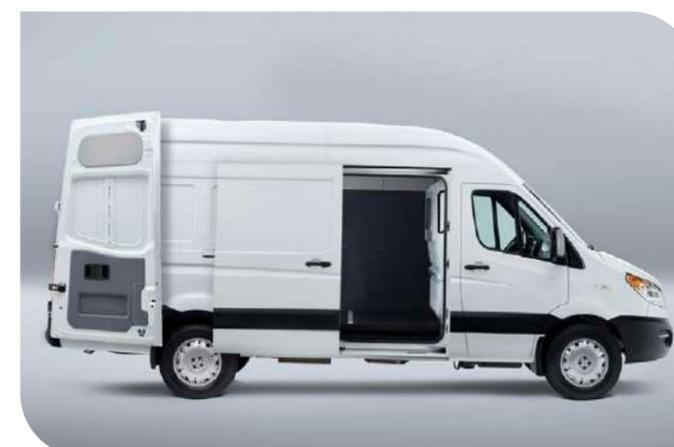
Габариты задних и боковой дверей позволяют комфортно производить погрузку как при помощи специальных устройств, так и вручную, чтобы ничто не мешало делу. Угол открывания задних створок до 270 градусов, фиксация под прямым углом для максимально удобной погрузки.\*
