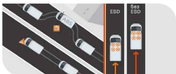
Антиблокировочная система и система распределения тормозных усилий (ABS и EBD)
